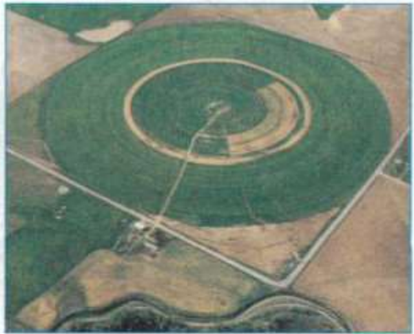
Hình 14.4 - Hệ thống tự động tưới xoay tròn
